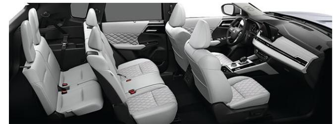
Les sièges de la 2<sup>e</sup> rangée divisés 40-20-40 et les sièges de la 3<sup>e</sup> rangée divisés 50-50 offrent de la polyvalence pour asseoir 4 occupants confortablement avec des articles de chargement plus longs.
